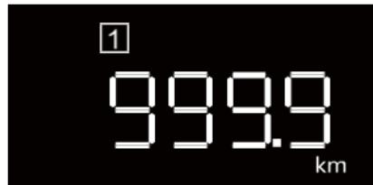
Muestra el kilometraje de la conducción actual. Este valor se restablecerá automáticamente cuando el vehículo se apague durante un período de tiempo, o pulsando prolongadamente la rueda selectora situada a la derecha del volante para restablecerlo.
