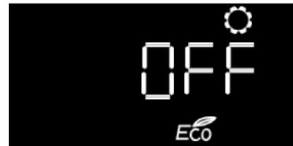
En la interfaz de ajuste del modo ECO, puede pulsar la rueda selectora de la derecha del volante para ajustar el modo ECO; y pulsar hacia arriba y hacia abajo la rueda selectora para seleccionar ON u OFF para activar o desactivar el modo ECO.
