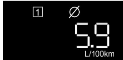
Muestra el consumo medio de combustible de la conducción actual. Este valor se restablecerá automáticamente cuando el vehículo se apague durante un período de tiempo, o pulsando prolongadamente la rueda selectora situada a la derecha del volante para restablecerlo.
