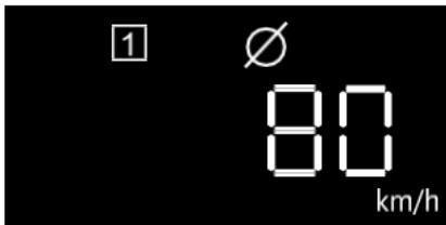
Muestra la velocidad media del vehículo en la conducción actual. Este valor se restablecerá automáticamente cuando el vehículo se apague durante un período de tiempo, o
