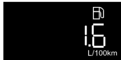
Muestra el consumo actual de combustible cuando el motor está funcionando. Cuando la velocidad del vehículo es inferior a 5 km/h,
