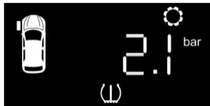
En la interfaz de control de presión de neumáticos, pulse brevemente la rueda selectora situada a la derecha del volante para mostrar la presión de los neumáticos. Pulse brevemente el botón LEFT/RIGHT de la derecha del volante para mostrar el estado de la presión de los neumáticos de las cuatro ruedas en ciclo.
