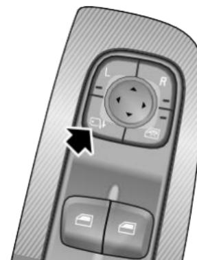
Al desbloquear/bloquear el vehículo, los retrovisores exteriores se desplegarán/plegarán automáticamente. Esta función puede ajustarse en la interfaz correspondiente en "Ajuste del vehículo" en la pantalla de entretenimiento.
