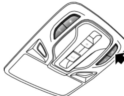
Pulse el botón de On/Off como se indica en la flecha para activar/desactivar el funcionamiento automático.
