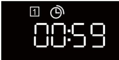
Muestra el tiempo de conducción actual. Este valor se restablece automáticamente cuando el vehículo se apaga durante un período de tiempo, o pulsando prolongadamente la rueda de pulgar a la derecha del volante para restablecerlo
